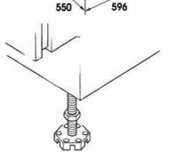
Четыре регулируемые ножки позволяют отрегулировать высоту стиральной машины в диапазоне от 820 мм. (необходимо снять установленные гайки и заменить их гайками 5 мм) до 840 мм (необходимо поднять ножки и заблокировать их, завернув стопорные гайки до нижней стороны основания).
