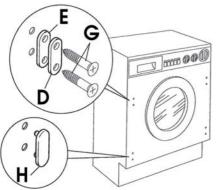
Установите пластинку (D) в правой или в левой части машины в соответствии с вашими требованиями. Подложите под пластинку резиновые шайбы и закрепите ее с помощью винтов (G). Установите колпачок (H) в нижней позиции.
