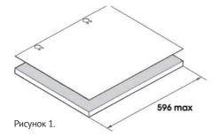
Высверлите в дверце отверстия, используя для этого картонный шаблон, как показано на рис.1. Это необходимо для того, чтобы установить петли и магнит для закрывания дверцы в правой или левой позиции в соответствии с вашими требованиями. Положение петель измеряется от верхнего края дверцы.
