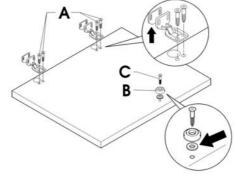
Закрепите петли с помощью 4 винтов (A). Закрепите магнит (B) с помощью винта (C).
