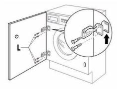
Закрепите дверцу с петлями с помощью винтов (L) на передней стороне стиральной машины.
