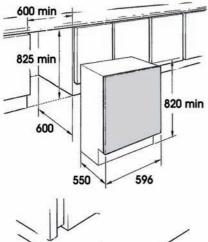
Установите стиральную машину в нишу нужного размера. Можно использовать нижний плинтус, если это позволяют размеры ниши.
